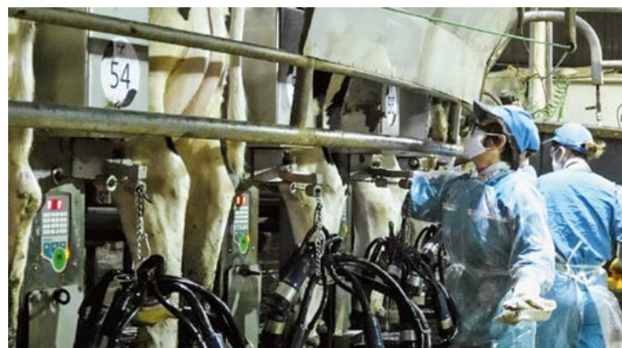
Egy a 8 db 80 állásos karusszal fejőberendezésből Afimilk tejmérővel
